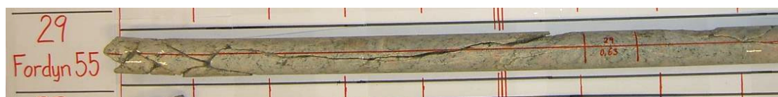
Figur 5.5 Bergkärna från hål 29. Avståndet mellan markeringarna på bilden är 10 cm.
