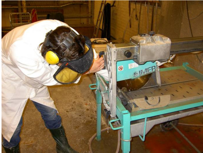
Figur 4.11 Sågning av borrhärnor med kapsåg.
