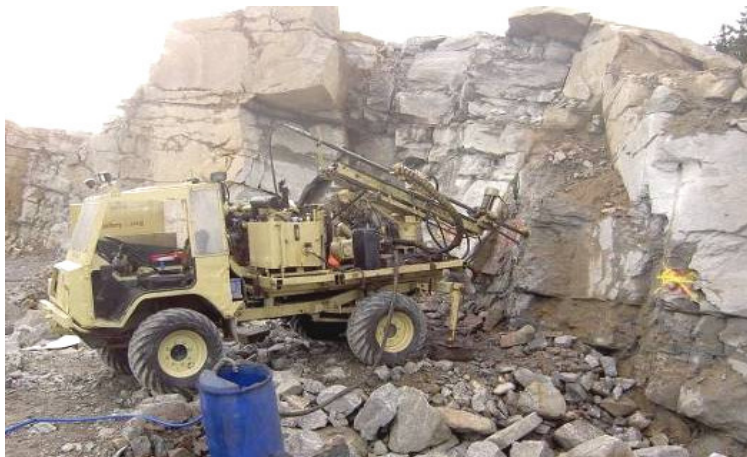
Figur 4.9 Kärnbrörning för uttagning av bergkärnor.
