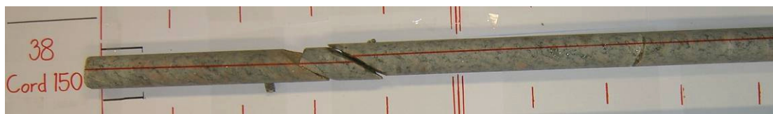
Figur 5.14 Bergkärna från hål 38. Avståndet mellan markeringarna på bilden är 10 cm.
