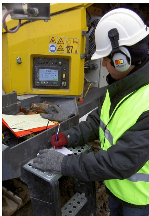
Figur 4.5 Registrering av borrsjunkning.
