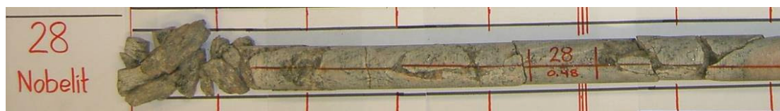
Figur 5.2 Bergkärna från hål 28. Avståndet mellan markeringarna på bilden är 10 cm.
