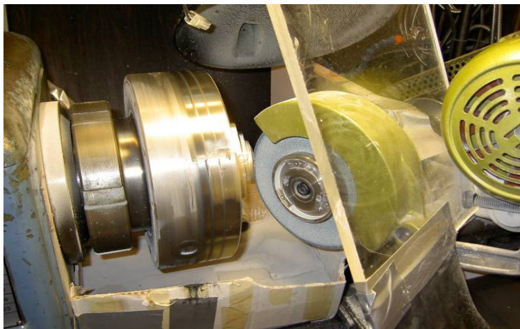
Figur 4.12 Slipning av provbitar med hjälp av en svarv.
